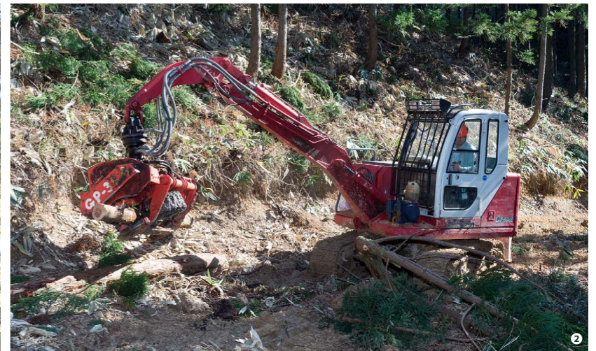
① 伐採した木を丸実自慢のロングリーチグラブがつかんで引っ張り上げる！伸縮式のアームは12メートル先の材をつかむことが可能だ ② ロングリーチグラブで引き上げた材をプロセッサで玉切りし、仕分ける。伐倒→グラブで引き上げ→プロセッサで造材と、作業道から離れた木でも効率の良い流れで生産性を高める ③ 和やかな雰囲気、休憩タイム、チームワークの良さは作業効率はもちろん、安全な作業にもつながっている
